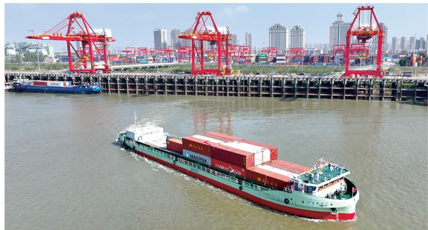
新华社武汉11月16日电 没有柴油机隆隆轰鸣,没有烟囱冒出的缕缕黑烟,只在船尾设置4个箱式电源,120标箱纯电动集装箱船就能在长江和汉江破浪前行……16日,汉江首艘纯电动集装箱示范船“华航新能1”在湖北武汉首航,由此开启汉江航运的电化时代。
