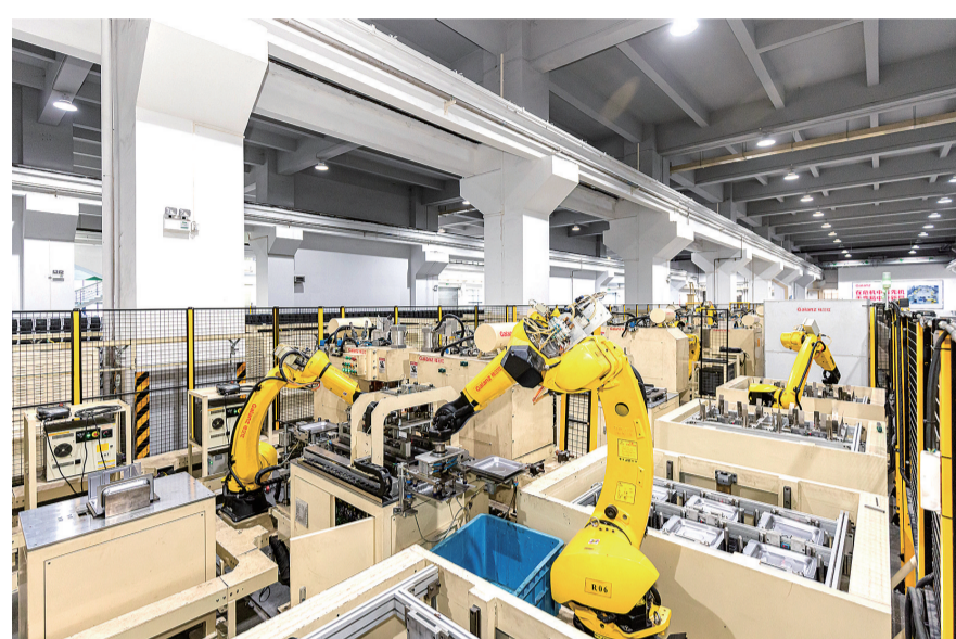
格兰仕集团工业4.0基地微波炉腔体焊接自动化生产线。/资料图
